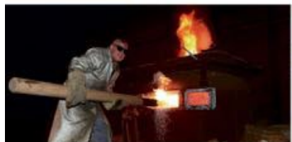
Glockenguss ist Handarbeit vom Mauern des Kerns über das Auffragen verschiedener Lehmsschichten bis zum Umrühren der 1080 Grad heißen Glockenspeise im Ofen. Und auch nach dem Guss und einer vierwöchigen Abkühlphase ist Präzisionsarbeit vonnöten, denn die Glocke will gesäubert und poliert sein, ehe der erste Glockenschlag vollzogen wird. Dann erst nämlich stellt sich heraus, ob die Glockengelungen ist oder, was zwar selten, aber eben auch vorkommt, die harte und schweißtreibende Arbeit eines Vierteljahres für die Arbeit war.
