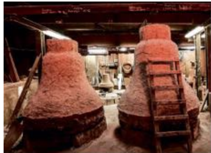
Glockenguss ist Handarbeit vom Mauern des Kerns über das Auffragen verschiedener Lehmsschichten bis zum Umrühren der 1080 Grad heißen Glockenspeise im Ofen. Und auch nach dem Guss und einer vierwöchigen Abkühlphase ist Präzisionsarbeit vonnöten, denn die Glocke will gesäubert und poliert sein, ehe der erste Glockenschlag vollzogen wird. Dann erst nämlich stellt sich heraus, ob die Glockengelungen ist oder, was zwar selten, aber eben auch vorkommt, die harte und schweißtreibende Arbeit eines Vierteljahres für die Arbeit war.
