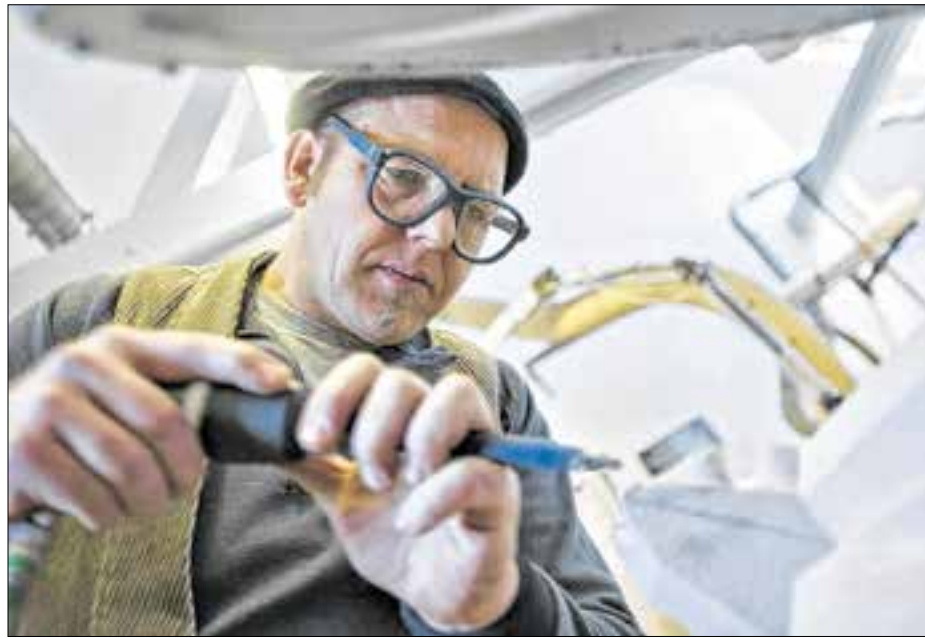
Dietmar Rudolf und der Stein – für manche Fialen bedarf es eines langen Atems. Da benötigt der Steinmetz 300, 800, ja sogar bis zu 1200 Arbeitsstunden.
