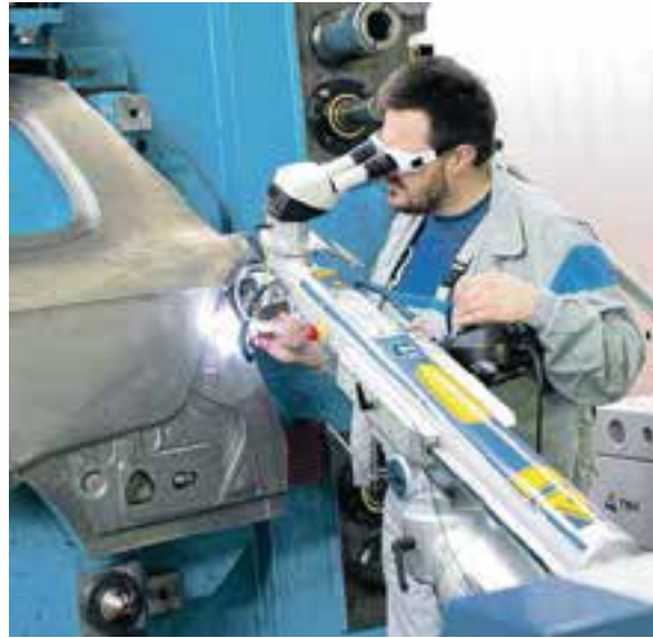
Ein VW-Mitarbeiter setzt im Werk Emden mit einem Laser-Schweiß-Roboter ein Press-Werkzeug instand.
